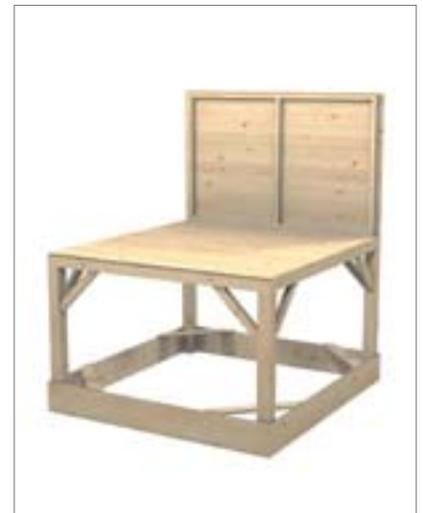
Die Rückwand **12** wird mit 4x **C** am Podest befestigt.
