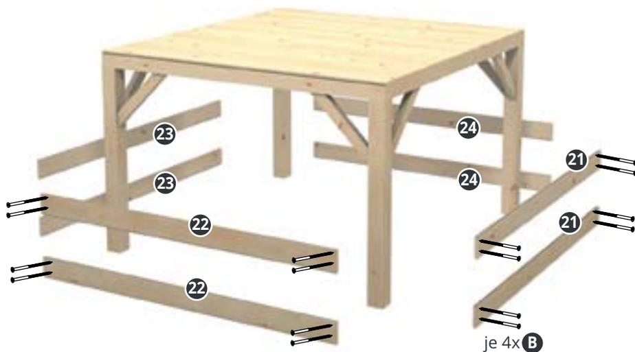
Jedes Sandkastenbrett **21-24** wird mit 4x **B** an den Stelzen befestigt.
