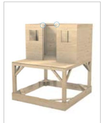
Die Fensterwände **10a+10b** werden mit je 2x **C** von innen am Podest und mit 3x **C** an der Seitenwand befestigt.
