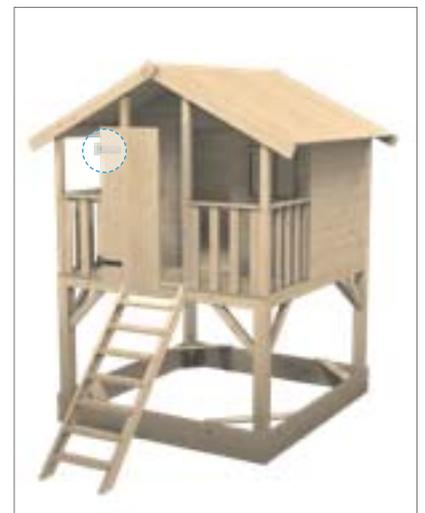
Die 2 Scharniere **G** werden von aussen mit 3x **A** an der Tür **14** und mit 4x **A** am Rahmen befestigt.
