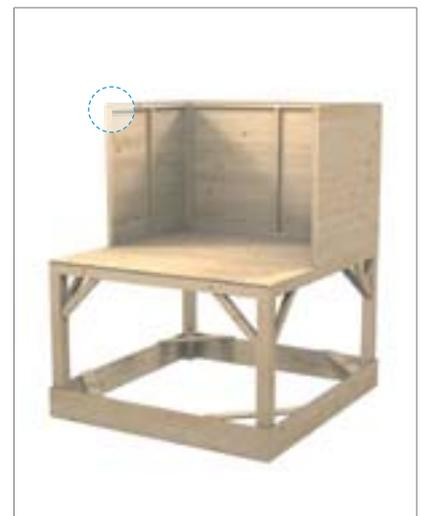
Die Seitenwände 11a+11b werden mit 3x C am Podest und mit 3x C an der Rückwand befestigt.
