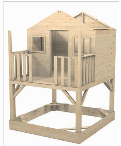
Das Geländer wird am Podest mit zwei Schrauben befestigt.
