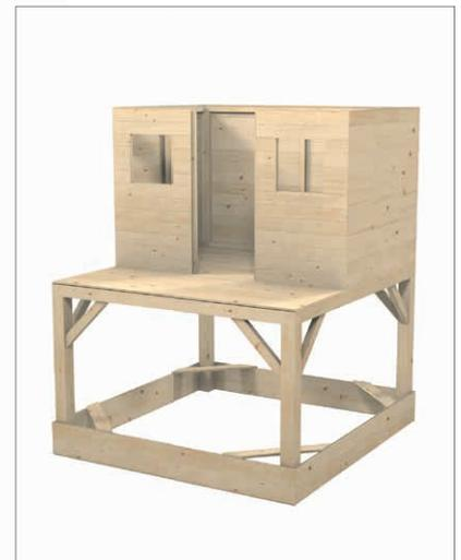
Die Wände werden mit je zwei Schrauben von innen am Podest und drei an der Seitenwand befestigt.
